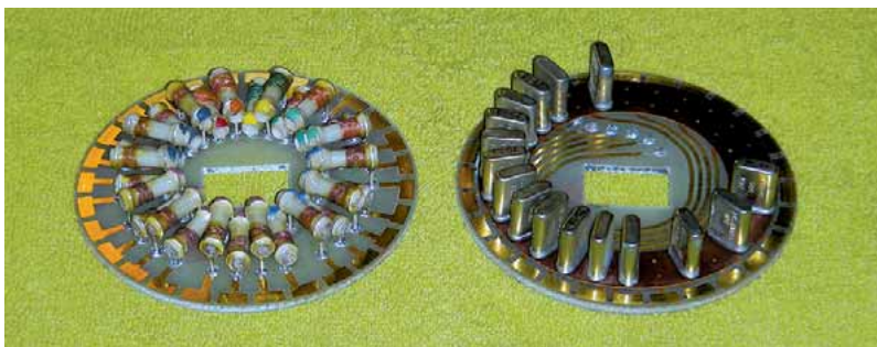
Bild 6: Zwei herausgenommene Schaltscheiben mit Spulen und Quarzen
